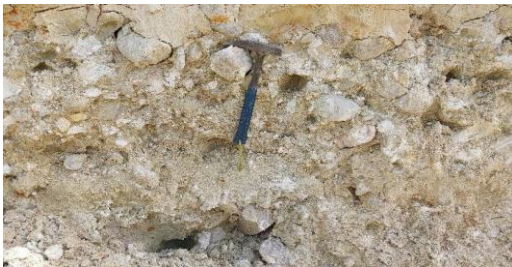
Carrière de galets siliceux dans leur matrice silico-argileuse à Vaunac-St-Jean-de-Côle (Dordogne) © V. Peureux Imerys
